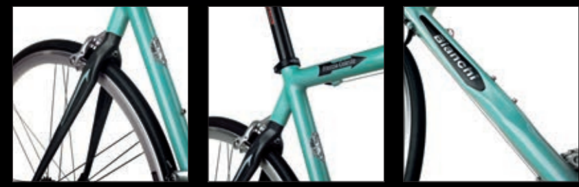
NUOVA FRECCIA CELESTE HC CON TECNOLOGIA HYDROFORMING A SALDATURE INVISIBILI.
